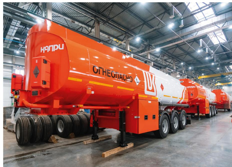
■ На сборке алюминиевый полуприцеп-цистерна для доставки топлива на АЗС сети «ЛУКОЙЛ»
